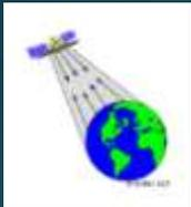
**Sensori radar attivi :** emettono un'onda elettromagnetica, diretta verso l'oggetto di indagine. La radiazione riflessa dall'oggetto viene poi registrata e misurata dal sensore, operano nella frequenza delle microonde.
